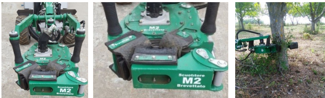
Fig. 6: supporti stratificati in gomma, tenuti assieme da bavette anch'esse in gomma
