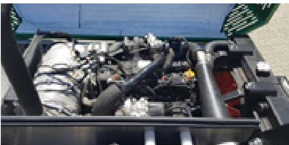
L' **impianto idraulico maggiorato** è così composto: per la trasmissione vi sono due pompe tandem a portata variabile che comandano i motori idraulici di avanzamento per ogni singola ruota con circuiti separati; mentre una pompa indipendente alimenta le prese idrauliche della macchina, sempre con circuito separato, un'altra a circuito alimenta l'idroguida.
